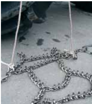
Narun avulla kettinki on helppo asentaa renkaalle.
