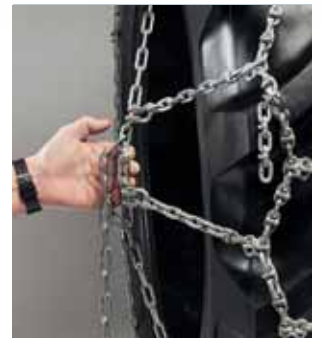
Yhdistä kulutuspuolelta railoliitoslenkit toisiinsa jonka jälkeen sivulukot; ensin sisäpuolinen lukko. Älä unohda jälkikivistystä lyhyen ajan jälkeen. Kettinki on sopivan kireä jos nyrkki sopii renkaan sivun ja sivukettingin väliin.
